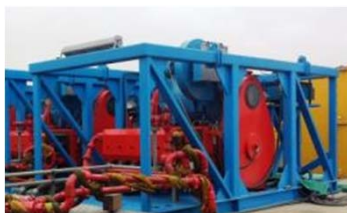
6000马力变频驱动压裂泵
