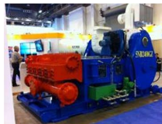
2400马力五缸高压钻井泵
