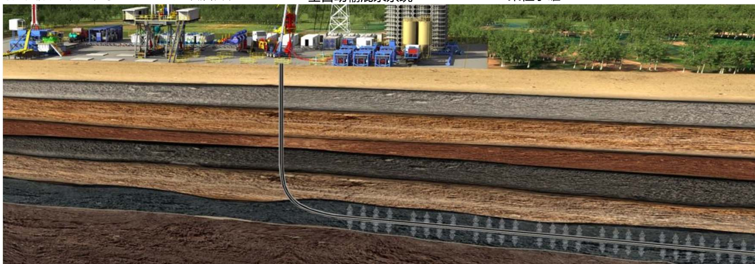
水力喷砂环空分段压裂
