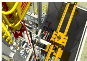
二层台排管系统
