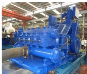
直驱五缸钻井 泵，7500Psi
