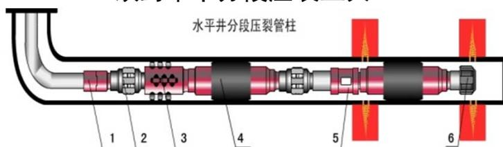
1. 安全接头 2. 扶正器 3. 水力锚 4. 压差式封隔器 5. 导压喷砂器 6. 扶正丝堵
